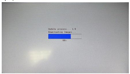
Примечание: Если после включения радиоприемника процесс обновления не запустился, то необходимо, не извлекая SD карты, перезагрузить радиоприемник долгим нажатием на ручку регулировки громкости.
